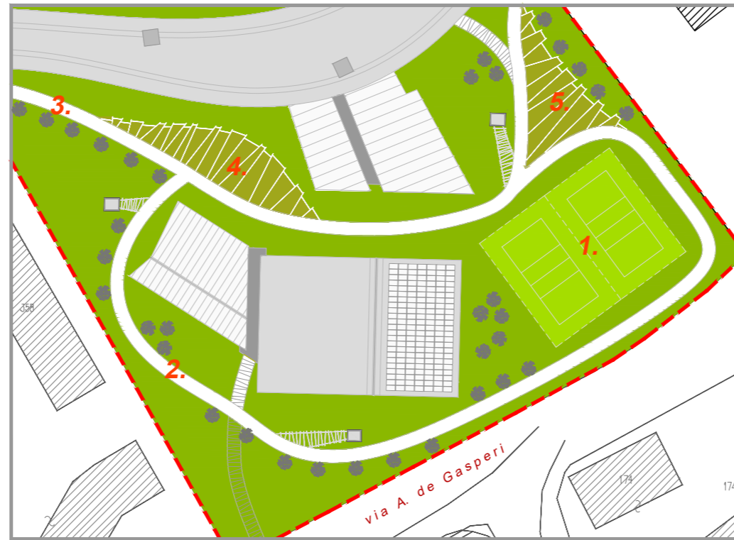
stralcio planimetrico All'esterno sono previsti altri due campi scoperti 1., oltre a due percorsi per jogging 2.-3. ed aree attrezzate per fitness outdoor e street workout 4. e 5.
